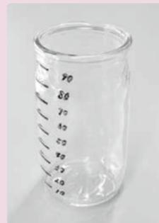
\* 雨量カップは開口部から底面までが同じ面積の容器で、重量があるものが最良。油性ペンで1cmごとに線を引いておくと、観測がしやすい。
