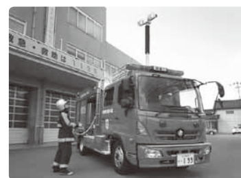
電動昇降照明で夜間の作業も万全
